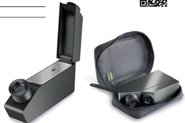
Analoge Refraktometer KERN ORA-A
